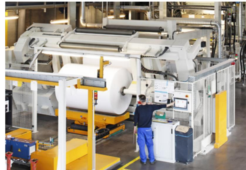
**Effizient** Die Rollen haben nach der Beschichtung eine Temperatur von etwa 30 Grad. Sie werden in Zukunft genutzt, um das Lager zu heizen.
